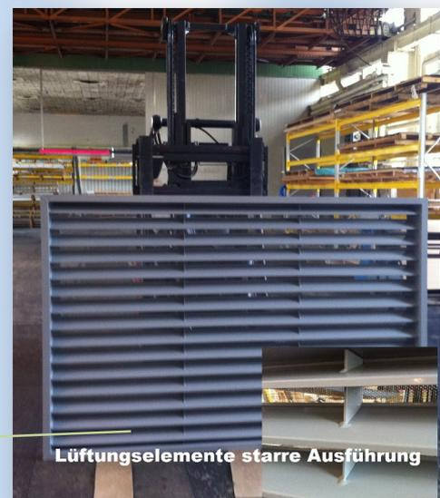
Größen nach Ihren Vorgaben . Bsp.: Maße (siehe Bild) 1200 x 2000 mit einem Lüftungsquerschnitt von **1,2m<sup>2</sup>** bei einer Fläche von ca. 2,38m<sup>2</sup> Einbaufläche.
